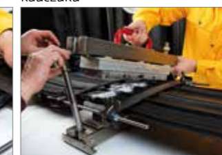
Wykonanie posypki i wsunięcie taśmy do sprzętu wulkanizującego
