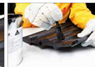
Nanoszenie roztworu wulkanizującego na powierzchnię kauczuku
