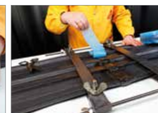
Łączenie taśmy z dociskaniem zaciskami mocującymi
