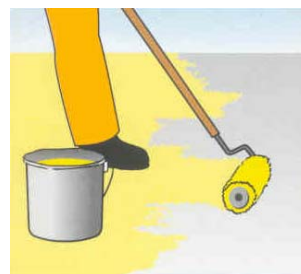
Nakładanie warstwy gruntującej: Sikafloor®-10 / -13 Pronto wałkiem lub szczotką o średnim lub długim włosiu np.: Polyplan.
