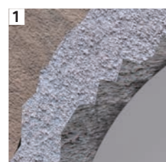
1 Beton natryskowy (warstwa zewnętrzna)
