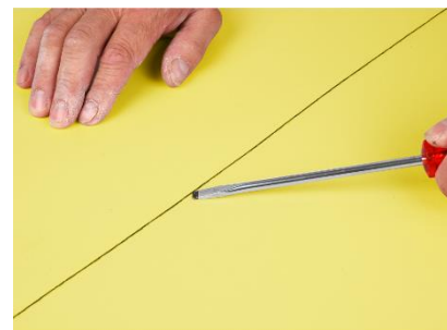
Przeciąganie płaskiego śrubokręta wzdłuż zgrzewu
