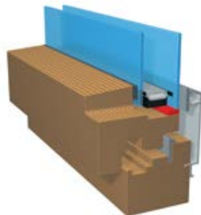
Klejenie krawędzi szkła za pomocą technologii Sikasil® i SikaFast
