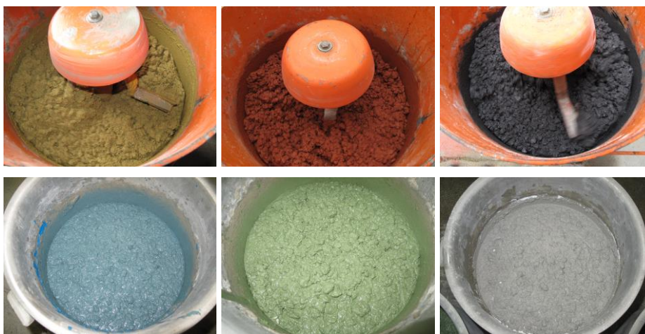
Fot. 10. Kolorowy beton - świeża mieszanka betonowa.
