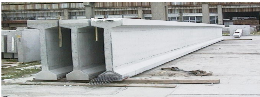
Fot: 12. Widok wyprodukowanych dźwigarów strunobetonowych – technologia ASCC – rok 2004
