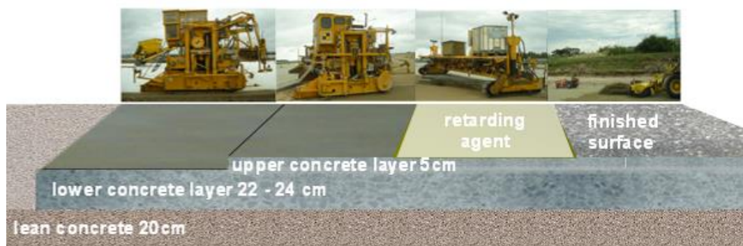
Fot. 5. Budowa nawierzchni betonowej – technologia „płukanego betonu” – autostrada A2 Nowy Tomyśl – granica państwa. Przekrój przyjętego typu konstrukcji - płyta z betonu cementowego, dyblowana, ułożona na podbudowie z chudego betonu.
