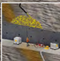
Wypełnianie kawern i pustek
