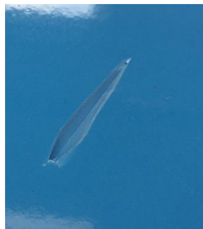
Fot. 1: Nacięcie w kształcie „kociego oka“
