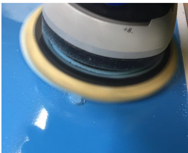
Fot. 8: Szlifowanie naprawianego obszaru
