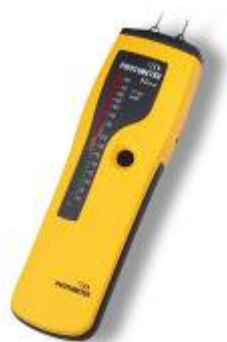
Pomiar wilgotności podłoża: Wilgotność < 18 % wilgotności drewna. Przyrząd pomiarowy np. Protimeter Mini
