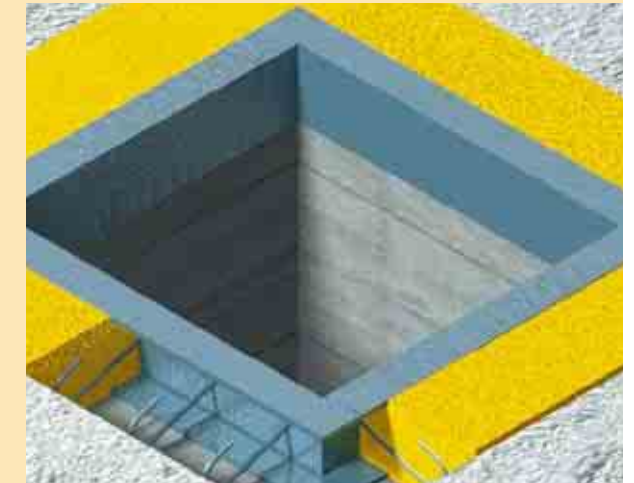
Osadzanie elementów stalowych
