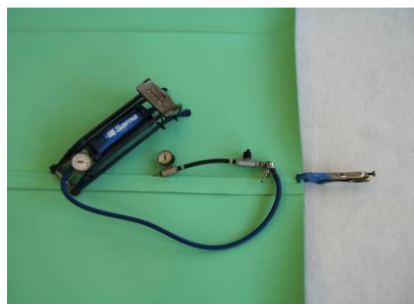
Badanie ciśnieniowe podwójnego zgrzewu pompą ręczną
