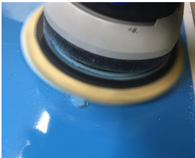
Fot. 8: Szlifowanie naprawianego obszaru
