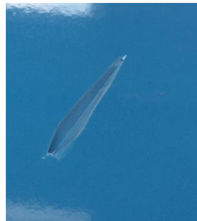
Fot. 1: Nacięcie w kształcie „kociego oka”
