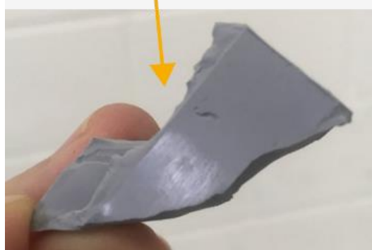
Rys. 43: Brak przyczepności na wewnętrznej stronie szyby - ŻŁE
