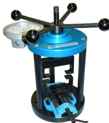
"Ban VEC" ręczne stanowisko testowe z pomiarem analogowym (w ofercie GINGER CEBTP)
