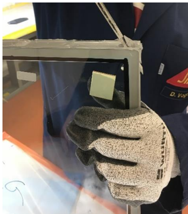
Rys. 40: Pociągnąć dłuto w górę
