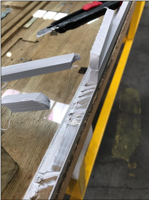
Rys. 35: Dobra przyczepność, pozytywny test demontażu próbnego
