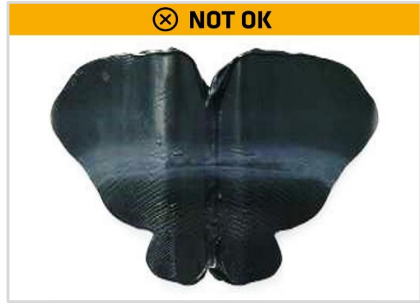
Zdjęcie 7: Rozłożyć folię: Wynik negatywny = wymieszanie niewystarczające
