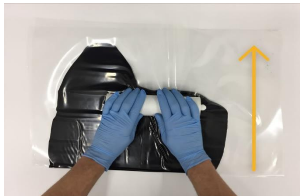
Zdjęcie 5: Naciskać/wałkować uszczelniacz w kierunku prostopadłym do zagięcia
