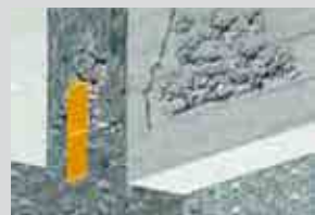
uszkodzenia membrany = hydroizolacyjnej=
