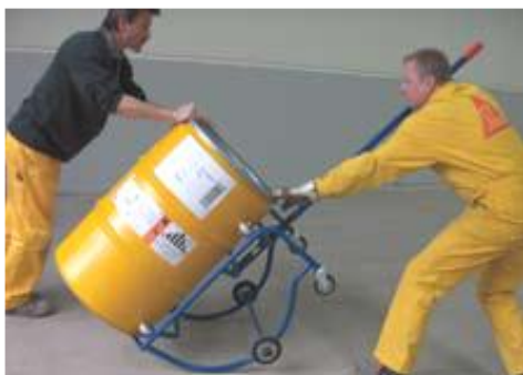
Operowanie 200 kg beczkami jest łatwiejsze przy pomocy „wózka do beczek”.
