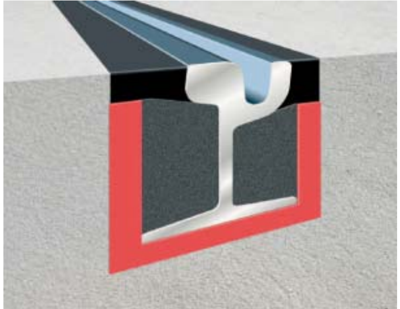
Schemat ciągłego mocowania z blokami komorowymi.
