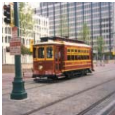
Memphis/Tennessee, USA. Szyna ciągłe podparta (zatopiona). Bardzo proste i prymitywne zawieszenie historycznych pojazdów, używanych w komunikacji tramwajowej, wymaga efektywnego tłumienia wibracji. Ważna jest także ochrona podziemnych kabli, rur i innych urządzeń przed destrukcyjnym działaniem prądów błądzących.
