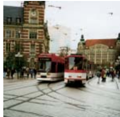
Erfurt/Niemcy, Anger. Dzięki zastosowaniu w pełni zatopionej szyny Ri60 ograniczono wibracje o 40%.
