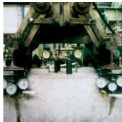
Badanie dynamiczne na urządzeniu pulsacyjnym
