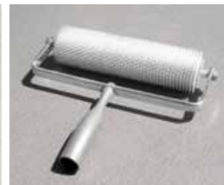
Wałki kolczaste do odpowietrzania: z lewej kołki stalowe, z prawej – plastikowe
