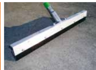
Zamykanie zasypki piaskowej zwykłą pacą z prostą krawędzią lub raklą
