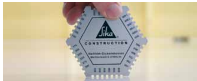
Sprawdzanie grubości nałożonej warstwy
