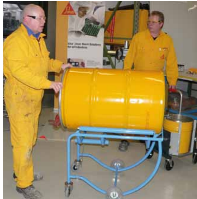
Wózek do beczek: umożliwia przekręcenie beczek z ich podniesieniem i transport poziomy
